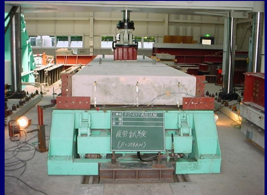
繰り返し荷重載荷試験状況 (200万回)
