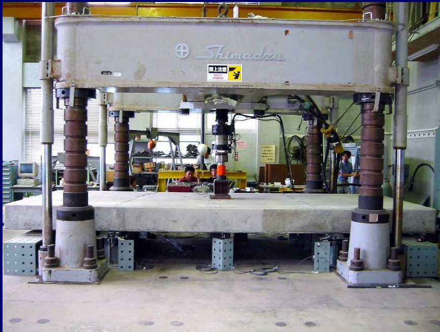
荷重分配試験状況 (中央載荷)
