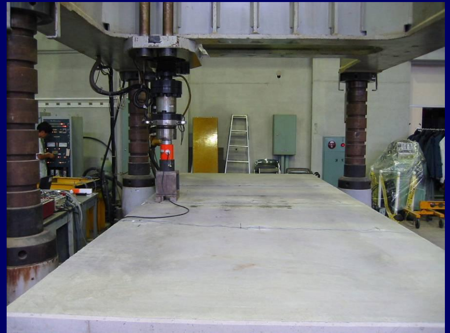
荷重分配試験状況 (偏心載荷)
