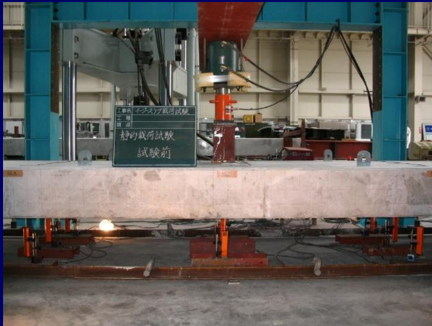
静的破壊試験状況
