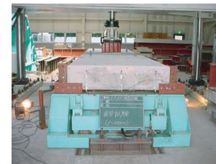
繰り返し荷重載荷(200万回)試験状況
